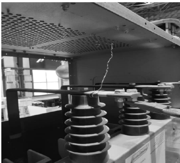
Rys.6. Symulacja pierwszego defektu – typ 1
