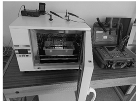
Rys.2 Stanowisko laboratoryjne do pomiarów prądów polaryzacji i depolaryzacji próbek izolacji transformatorowych z widocznym stabilizatorem temperatury otoczenia oraz miernikiem SONEŁ® MIC-15k1
