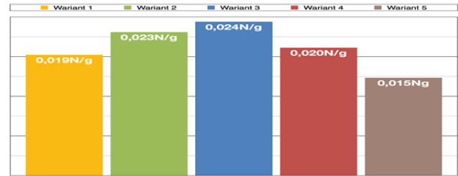
Rys.13. Współczynnik „siła przypadająca na jednostkę masy miedzi” (ang. force per copper mass) \frac{Q_A}{m_{Cu}} dla wszystkich rozważanych 5 wariantów.
