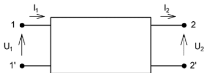
Rys.1. Schemat ogólny czwórnika, prądy zwrócone od wejścia do wyjścia.
