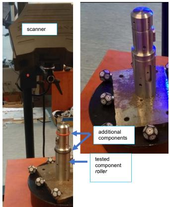
Fig. 9. Scanning the *roller* a) b)
