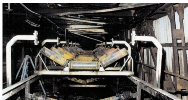
Rys.10. Zdjęcie taśmy transportowej po pożarze spowodowanym zatarciem rolki prowadzącej [15]
