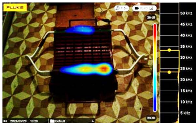
Rys. 7. Lokalizacja WNZ w cewce nowej, nieprawidłowo impregnowanej, przy napięciu 3,5 kV (znamionowe napięcie fazowe U_{IN} = 3,46 kV)
