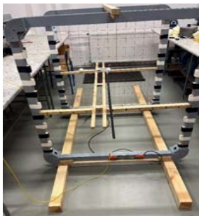
Rys. 6. Zadajnik pola magnetycznego własnego projektu i wykonania podczas pomiarów jednorodności pola i wyznaczania współczynnika CF
