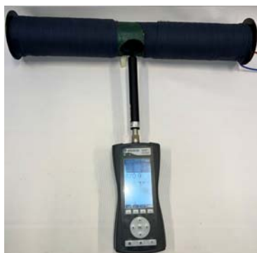
Rys. 10. Weryfikator wskazań podczas walidacji wraz z miernikiem SMP2 z sondą z czujnikami Halla WPH-DC
