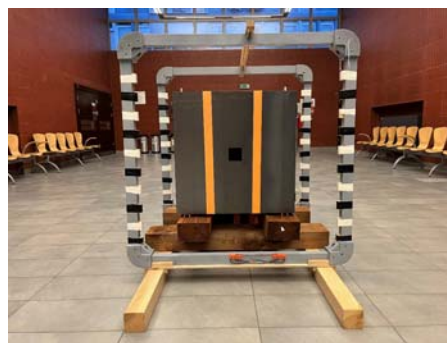
Rys. 8. Osłona pomiarowa z zamocowaną ścianą pomiarową wewnątrz zadajników pola z widocznym postumentem
