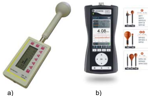
Rys. 9. Mierniki pola: a) ESM-100 Maschek, b) SMP-2 Wavecontrol
