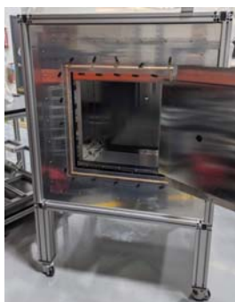
Rys. 3. Komora z mu-metalu firmy MuMETAL® Stress Annealed Sheet produkcji MAGNETIC SHIELD CORP. [9]
