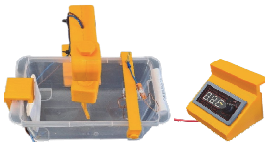
Rys. 4. Elementy stanowiska laboratoryjnego, wykonane w technologii druku 3D z pomarańczowego filamentu PLA.
