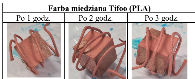
Rys.6. Przebieg procesu miedziowania próbki PLA pokrytej farbą miedzianą Tifoo.
