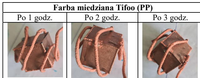
Rys.10. Przebieg procesu miedziowania próbki PP pokrytej farbą miedzianą Tifoo.
