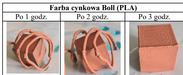
Rys.5. Przebieg procesu miedziowania próbki PLA pokrytej farbą cynkową Boll.
