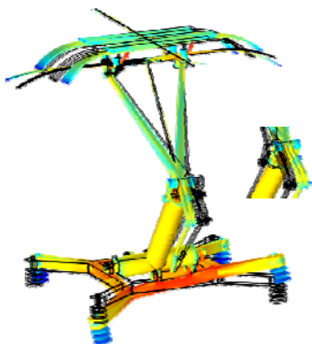
Rys. 9. Przemieszczenia środkowego przegubu pantografu
