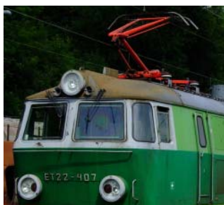
Rys.1. Pantograf typu DSA150 zamocowany na lokomotywie ET22 [21]
