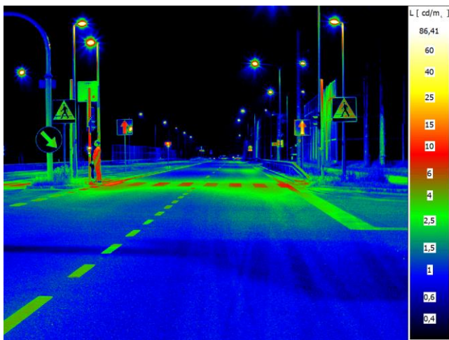
Rys. 5. Rozkład luminancji na przejściu dla pieszych i pieszy ubrany w jasnej kolorystyce w różnych etapach pokonywania przejścia.
