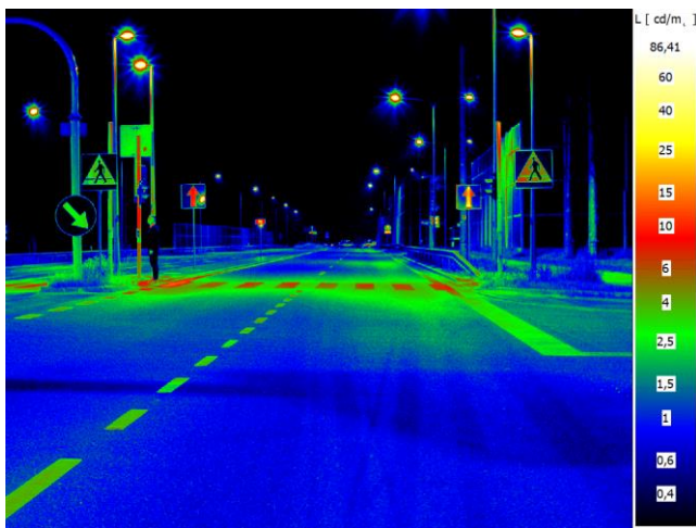
Rys. 4. Rozkład luminancji na przejściu dla pieszych i pieszy ubrany w ciemnej kolorystyce w różnych etapach pokonywania przejścia.
