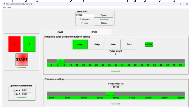
Rys.6. Ekran aplikacji do sterowania falownikiem, metoda IPDM z opcją rozpraszania widma (r-IPDM)
