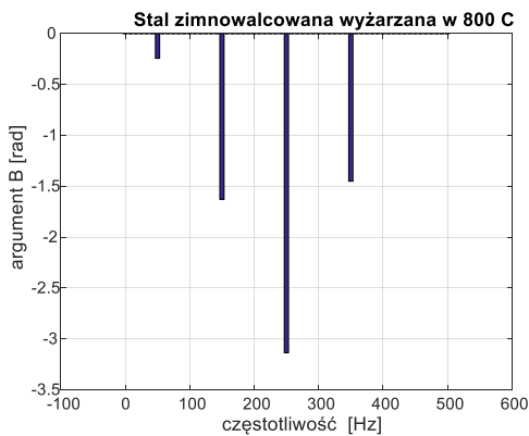
Rys. 13b. Widmo fazowe, przebiegu indukcji magnetycznej w próbce nr b1 przy wymuszeniu sinusoidalnym wyprostowanym jednopółkowo
