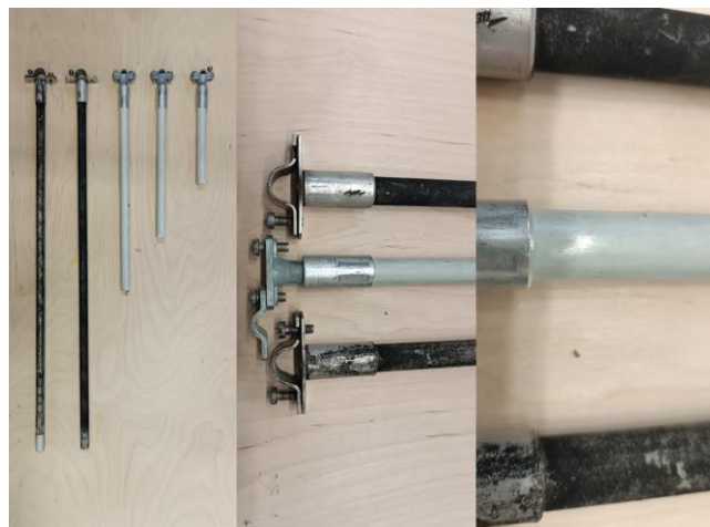
Rys. 5. Wsporniki separujące wykorzystane do badań laboratoryjnych – nowe i czyste (3 szt.) oraz wsporniki wykonane z tworzywa sztucznego wzmocnionego włóknem szklanym zdemontowane z rzeczywistego obiektu po 5 latach użytkowania (2 szt.).
