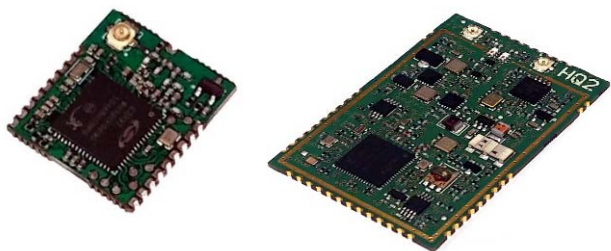
Rys. 3. Zdjęcia opracowanych modułów radiowych: Low-Cost (po lewej) i High-Quality (po prawej).
