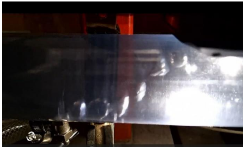
Rys. 7. Struktura przepływu dwufazowego woda-powietrze
