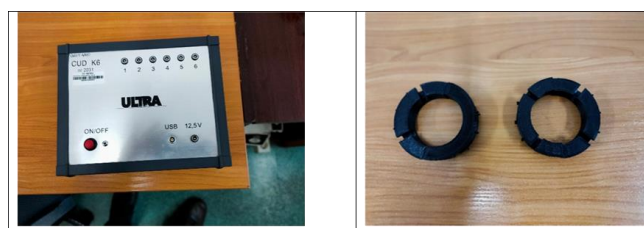
Rys. 1. Defektoskop wraz z obejmami mocującymi głowice ultradźwiękowe
