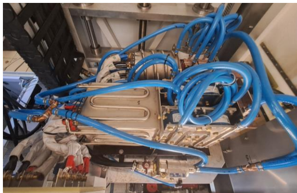
Rys.4. Prototypy transformatorów 100kW/50kHz i 50kW/300kHz
