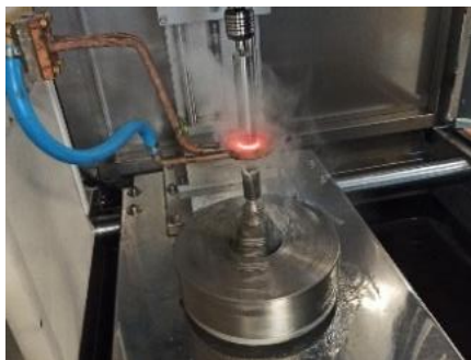
Rys. 6. Hartowanie indukcyjne próbek podczas badań
