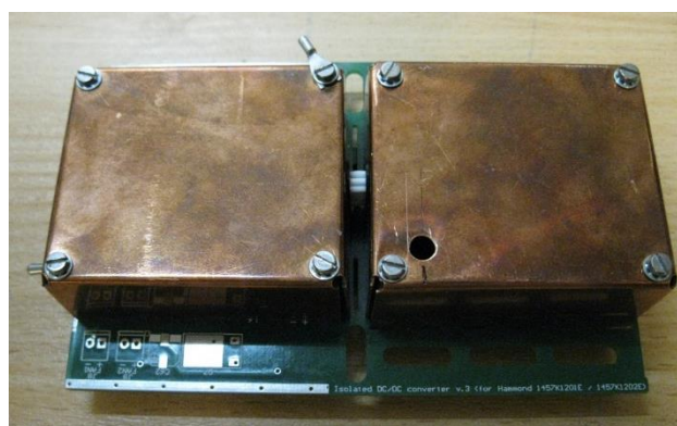
Rys. 2. Widok prototypu zasilacza z ekranami (bez obudowy)
