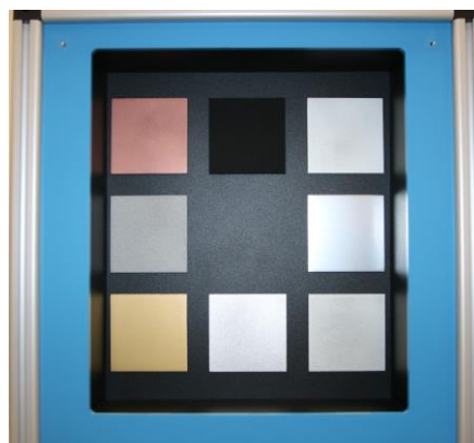
Rys. 7. Widok testu z powierzchniami o różnej emisyjności
