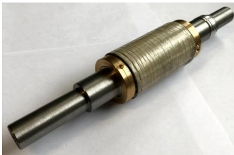
Rys.3. Wirnik prototypowego silnika PM BLDC z dodatkową opaską zwieszającą wytrzymałość na działanie siły odśrodkowej
